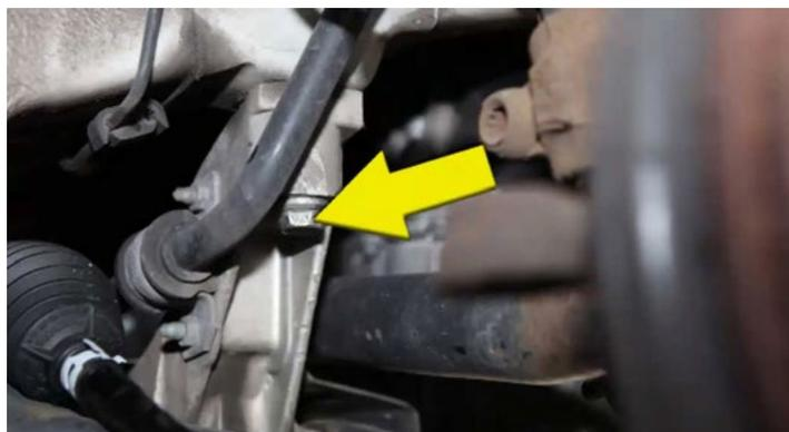
Desapertar os parafusos dos dois suportes do eixo. Agora é possível descer cuidadosamente a travessa do motor com os braços transversais e a caixa da direção.
