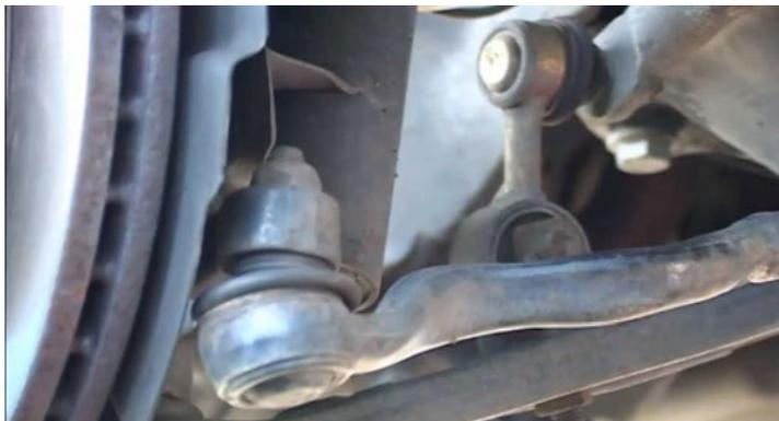
Desmontar as duas rótulas da barra da direção das mangas dos eixos.
