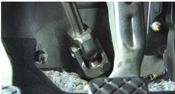
Desenroscar o parafuso de aperto no cardã da coluna da direção e desmontar o cardã da caixa da direção.
