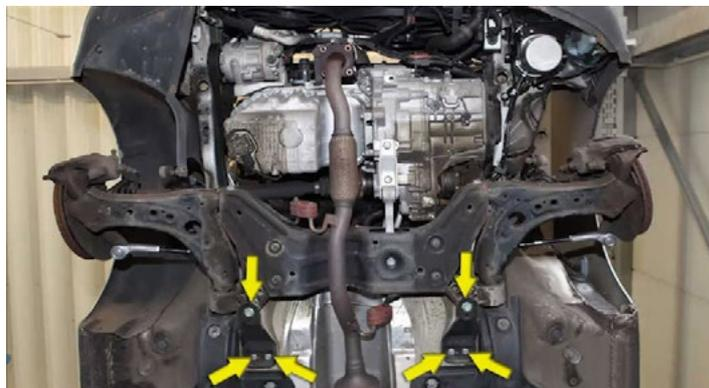
Após apoiar a travessa do motor é possível desmontar a chapa de retenção direita e esquerda.
