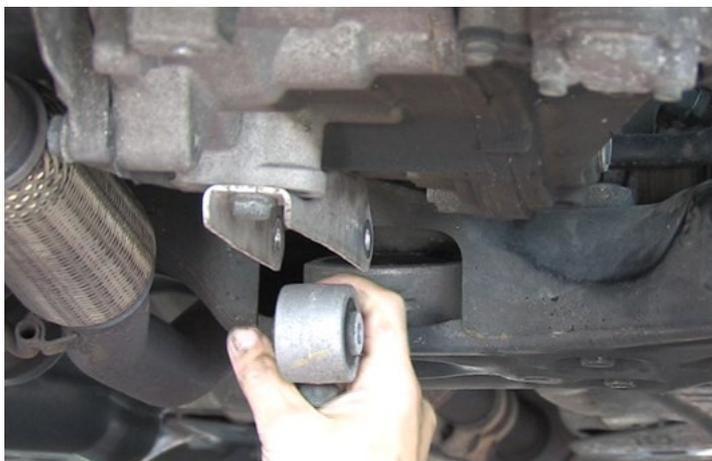
Desmontar o parafuso de fixação do apoio de binário no suporte do bloco do motor e puxar o apoio de binário para baixo.
