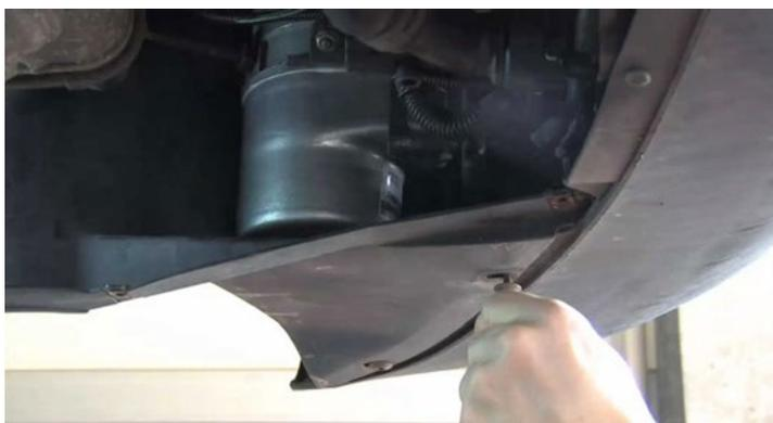
Remover o revestimento da cava da roda e todos os restantes revestimentos e coberturas que dificultem o acesso à bomba da direção e à respetiva cablagem.
