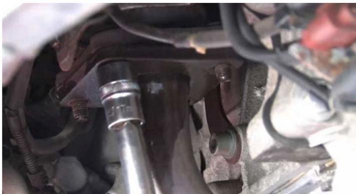
No passo seguinte deve-se retirar os parafusos de fixação do tubo de escape dianteiro do coletor de escape. Desmontar o tubo de escape.
