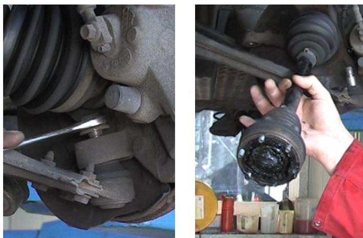
Desmontar a suspensão articulada esquerda da manga do eixo.
