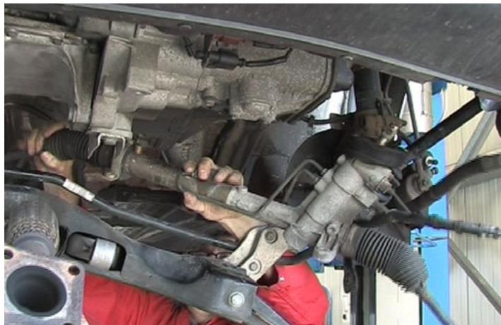
Para o próximo passo de trabalho é necessária a presença de um segundo mecânico. Desmontar a completa unidade composta pela caixa da direção, tubos flexíveis e unidade da bomba do motor.
