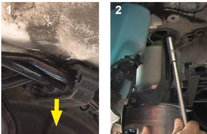
Desapertar as fixações dos cabos e tubos na carroçaria (1). Desmontar a bomba hidráulica, removendo os parafusos da pinça de fixação (2).
