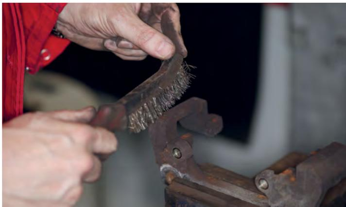
A limpeza minuciosa do suporte do travão é fundamental para o funcionamento perfeito do sistema de travagem. Especialmente as superfícies de encosto das pastilhas devem estar livres de sujidade e corrosão. Desta forma podem ser evitadas reclamações posteriores como, por exemplo, o encravamento dos travões, travagem desequilibrada e ruídos!
