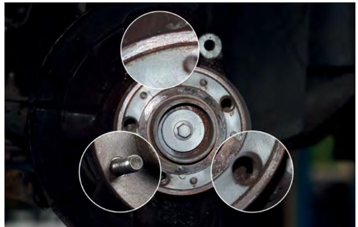
Inspeccionar a superfície de montagem do disco do travão, assim como os pinos e a rosca dos parafusos das rodas, para detectar corrosão ou danos. Cubos da roda danificados devem ser substituídos.
