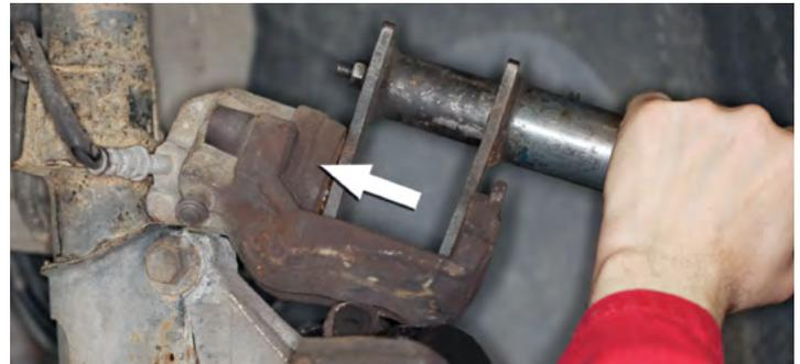
Utilizar uma ferramenta especial para posicionar o êmbolo na sua posição de partida. Assegure-se de que é possível empurrar o êmbolo uniformemente e facilmente para dentro da carcaça. No caso de os êmbolos se movimentarem com dificuldade, deve verificar novamente se existe sujidade ou corrosão. Em caso de dúvidas deve substituir a pinça do travão!
