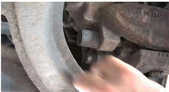
Retirar as tampas dos dois pinos guia e verificar se estes têm danos. Para um funcionamento correto é fundamental que as guias se movam normalmente, sem obstruções. Infiltrações de água e de pó provocam corrosão e dificultam a mobilidade da pinça do travão.
