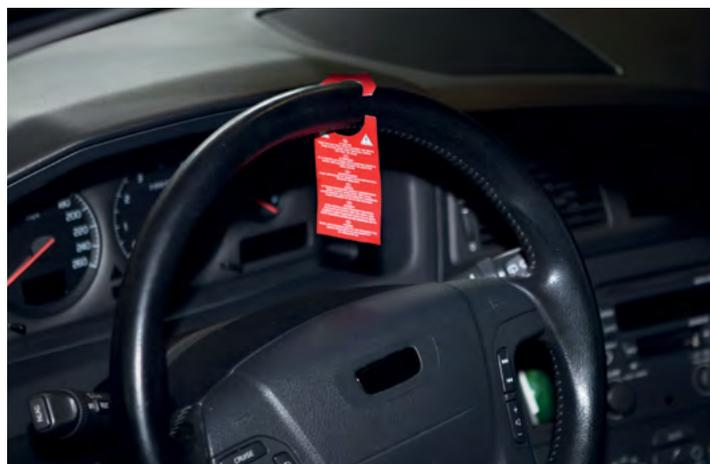
No final deve colocar a etiqueta no volante do veículo. Desta forma o seu cliente é informado sobre as recomendações sobre a utilização de travões novos e evita reclamações desnecessárias.
