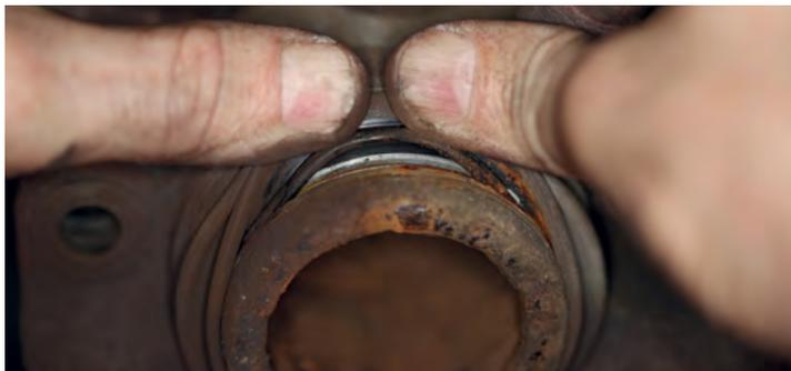
Controlar todos os componentes mecânicos e hidráulicos da pinça do travão. Fissuras nas borrachas de protecção favorecem infiltrações de pó e de água. Juntas de borracha dos cilindros danificadas implicam fugas do óleo de travões e consequentemente a destruição do material das pastilhas de travão. Verificar se os anéis vedantes de borracha não apresentam fugas.
