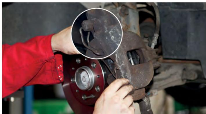
Montar a mola de retenção da pastilha. Ter atenção ao assento correto da mola nos pontos de fixação e no suporte do travão.
