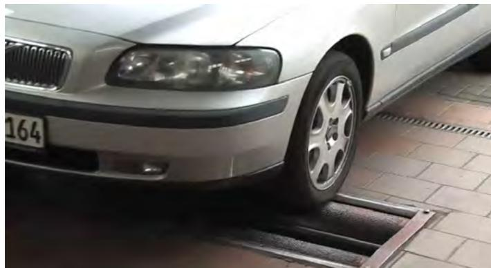
Depois de um teste de estrada deve controlar o bom funcionamento dos travões num banco de ensaio de travões. Ter atenção às regulamentações legais que visam as tolerâncias das forças de travagem por cada lado do eixo. Não esquecer de controlar também o funcionamento do travão de mão.
