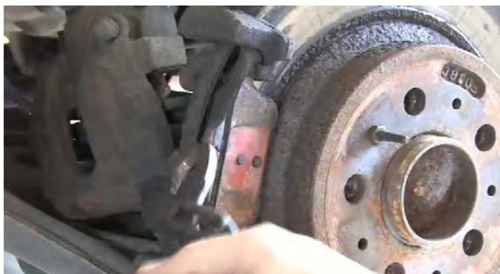
Retirar as pastilhas da pinça de travão e do suporte do travão. Verificar o estado dos tubos de travão e respectivas ligações. As peças com danos devem ser substituídas.
