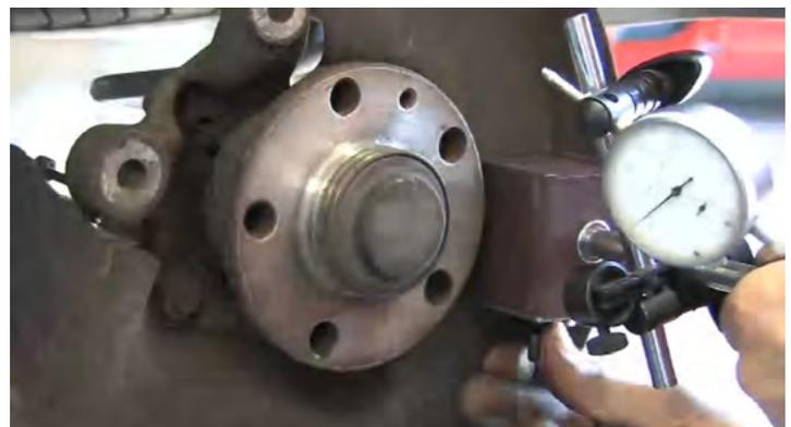
Se antes da reparação forem reclamadas vibrações na travagem do veículo, deve-se controlar o empeno do cubo da roda, antes de montar o disco do travão novo. Para esse efeito deve-se consultar os valores definidos pelo fabricante do veículo.
