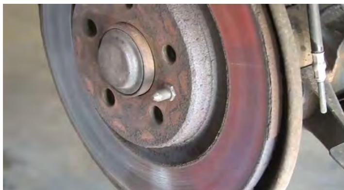
Desmontar primeiro o parafuso de fixação do disco do travão (se existente). De seguida, desmontar o disco do travão.
