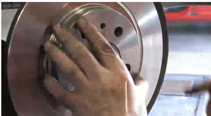
Montar o novo disco de travão no cubo da roda e fixar o parafuso de fixação (se existente) com o aperto especificado pelo fabricante do veículo.
