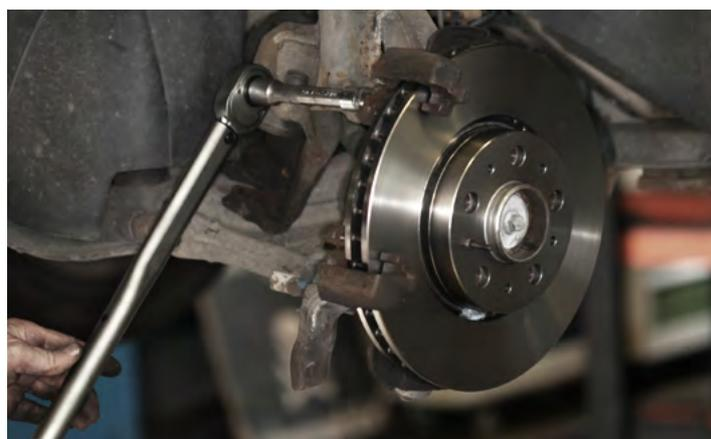
Montar o suporte do travão e eventuais componentes adicionais (neste caso o batente da direcção) e apertar os parafusos com o binário indicado pelo fabricante do veículo.
