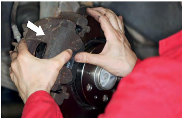
Colocar a carcaça da pinça juntamente com a pastilha na respetiva posição de montagem. Assegure-se de que ambas as pastilhas estão assentes correctamente.
