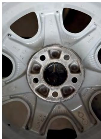
Antes de montar a roda deve-se limpar a parte interna da jante. Especialmente as superfícies de encosto do disco do travão devem estar livres de sujidade e corrosão. Jantes sujas podem ser a razão para discos danificados (desequilibrados).
