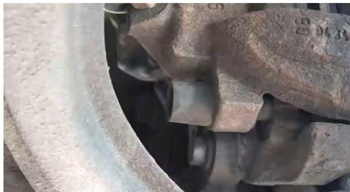
Desaparafusar os dois parafusos guia com uma chave de sextavado interno de 7mm do suporte do travão.
