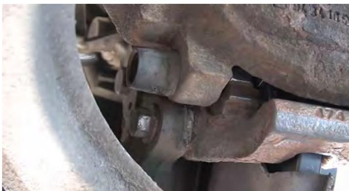
Utilize os parafusos deslizantes para fixar a estrutura da pinça ao suporte do travão. Apertar os parafusos deslizantes com o binário indicado pelo fabricante do veículo.
