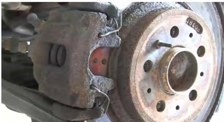
Desapertar cuidadosamente a mola lateral com um alicate adequado ou com uma chave de fendas, dos respetivos pontos de encaixe.
