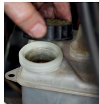
*Aviso: O nível do óleo é um indicador para o desgaste das pastilhas em todo o veículo. Se tiver substituído as pastilhas em apenas um eixo, deve controlar primeiro o travão do outro eixo do travão, antes de adicionar óleo dos travões, de modo a evitar um sobreenchimento do reservatório.*
