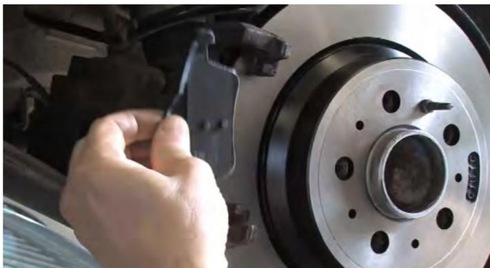
Posicionar a pastilha exterior no suporte. Assegure-se de que a pastilha não fica presa, esta deve mover-se livremente.
