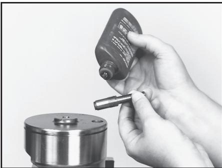
**Apply Locquic "T" primer and Loctite RC680**
