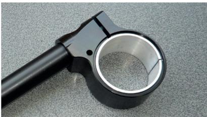
1. Tragen Sie, zur einfacheren Montage, ein geeignetes Fett auf den konischen Teil der Lenkstummel (Ende mit Gewindebohrung für die Klemmschelle) auf.
