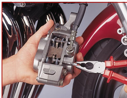
3. Демонтаж направляющих штифтов
