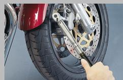
4. Затянуть при помощи динамометрического ключа.
