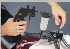
1. Удалить тормозную жидкость из компенсационного бачка.
