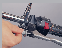
8. Отрегулировать гибкую тягу, 4 мм свободного хода.
