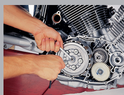
6. Отрегулировать зазор сцепления при помощи разобщительного механизма, в зависимости от транспортного средства.
