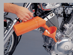
9. Залить масло, подготовить машину к езде, пробный пуск.
