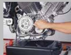
3. Enlever le plateau de pression du mécanisme d'embrayage, retirer les disques d'embrayage, retirer proprement et successivement les pièces.
