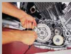
6. Installer la cloche d'embrayage sur le mécanisme de débrayage en fonction du modèle de véhicule.
