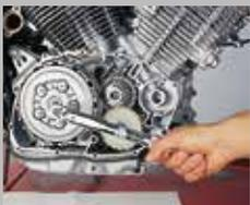
5. Commencer le montage avec garniture de friction, serrer les vis les unes après les autres sur le plateau de pression.
