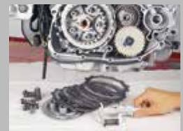
4. Contrôler : la longueur développée des ressorts, les disques en acier, le panier/l'entraîneur, remettre les pièces à neuf ou les remplacer.
