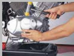
2. Desserrer les vis les unes après les autres, retirer le couvercle, nettoyer les surfaces d'étanchéité, faire attention aux douilles.
