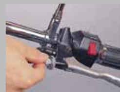
8. Réajuster le câble Bowden, en laissant un jeu de 4 mm.
