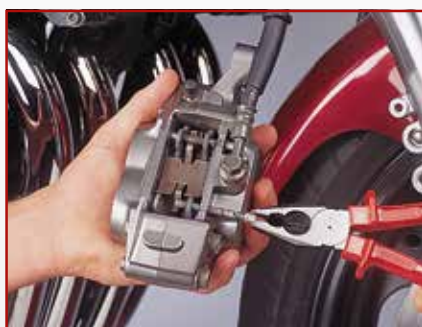
3. Retirer les axes de guidage
