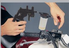
1. Extraer el líquido de frenos del depósito de compensación.
