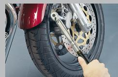
4. Mit dem Drehmomentschlüssel festziehen.
