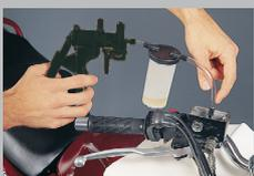
1. Bremsflüssigkeit aus dem Ausgleichsbehälter absaugen.
