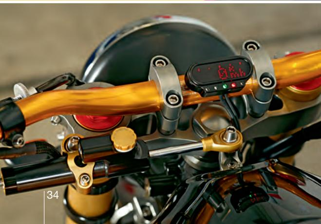
Nicht alles neumodische Material ist „ein Gelump“. Das multifunktionale Miniatur-Cockpit von Moto Gadget überzeugt auch Hardcore-Analogiker. Jene erfreut auch die urmechanische Lampenklemmung. Das AMA-Kürzel steht für die in Amerika liegenden Superbike-Wurzeln
