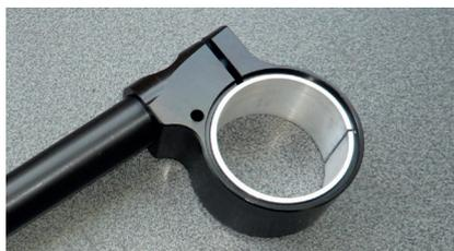
1. Tragen Sie, zur einfacheren Montage, ein geeignetes Fett auf den konischen Teil der Lenkstummel (Ende mit Gewindebohrung für die Klemmschelle) auf.
