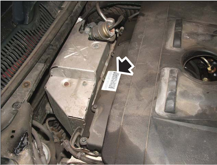
Motori 2,0 TDCi: - Illustrazione con l'etichetta dell'iniettore con la freccia - Vista laterale
