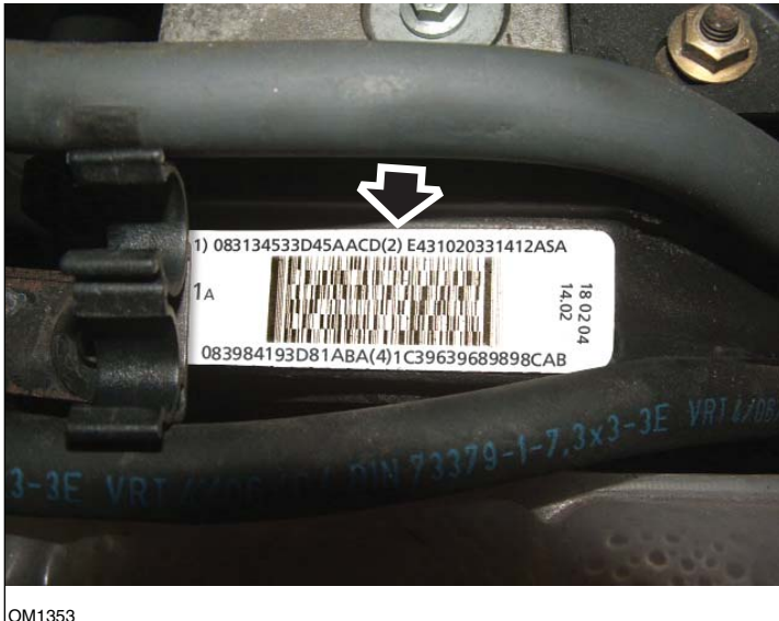
Etichetta iniettore - con quattro numeri a 16 cifre
