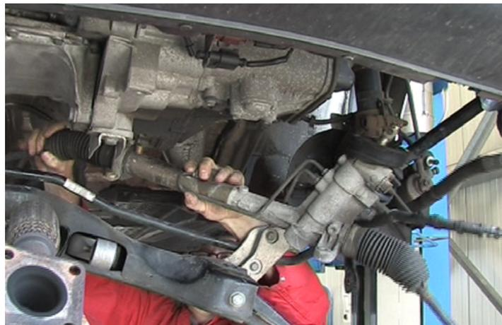
Per la successiva operazione è necessaria la presenza di un secondo meccanico. Estrarre l'unità completa (formata da sterzo, flessibili e gruppo motopompa) dal veicolo.
