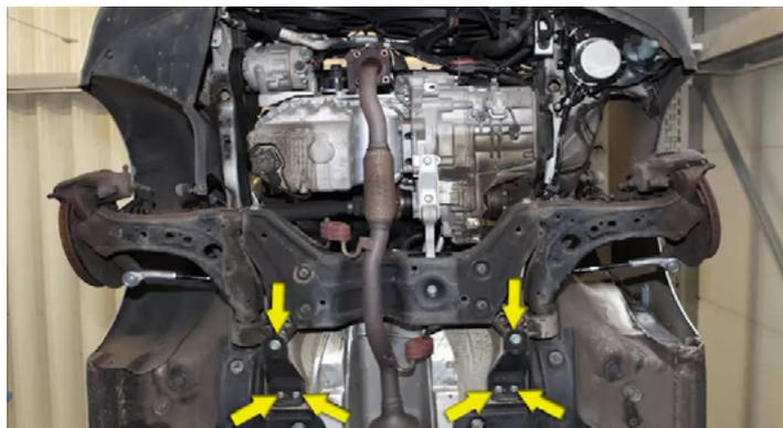
Dopo aver supportato la traversa del motore con un sollevatore idraulico, è possibile rimuovere il lamierino d'arresto destro e sinistro.
