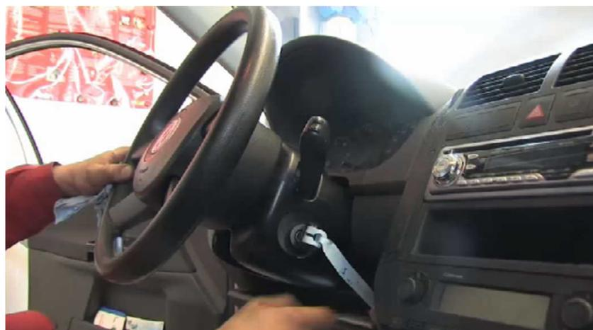
Prima di iniziare i lavori, scollegare la batteria e fissare il volante in posizione centrale con il bloccasterzo. Ciò impedisce una torsione e quindi un danneggiamento del cilindro di contatto dell'airbag.
