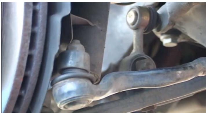
Smontare entrambe le teste delle barre d'accoppiamento dai fusi a snodo (leve delle barre d'accoppiamento).
