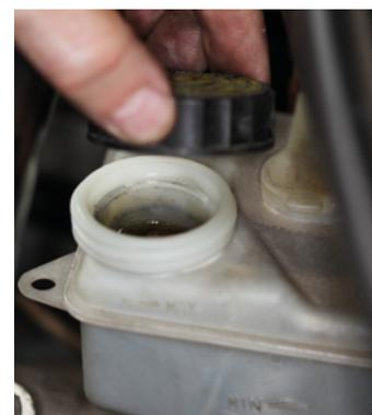
*Avvertenza: il livello del liquido è un indicatore dell'usura delle pastiglie del freno sull'intero veicolo. Nel caso fossero state sostituite le pastiglie del freno di un solo asse, prima del rabbocco controllare i freni dell'altro asse per evitare un riempimento eccessivo del serbatoio.*
