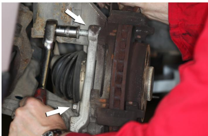
Rimuovere le due viti di fissaggio del portafreno. Estrarre il portafreno e controllare se è danneggiato o corrosivo.
