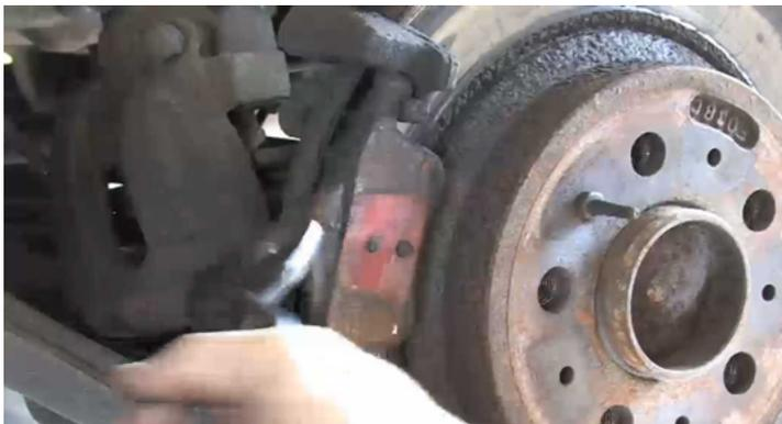
Rimuovere le pastiglie del freno dalla pinza del freno e dal portafreno. Controllare lo stato delle tubazioni e dei flessibili del freno. I componenti difettosi devono essere sostituiti.
