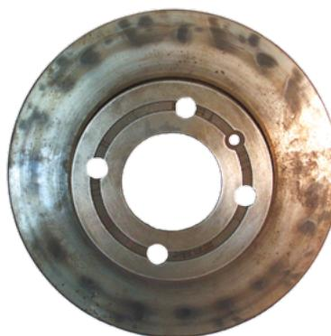
I punti surriscaldati si riconoscono dalle macchie scure. Il veicolo presentava una forte vibrazione del freno
