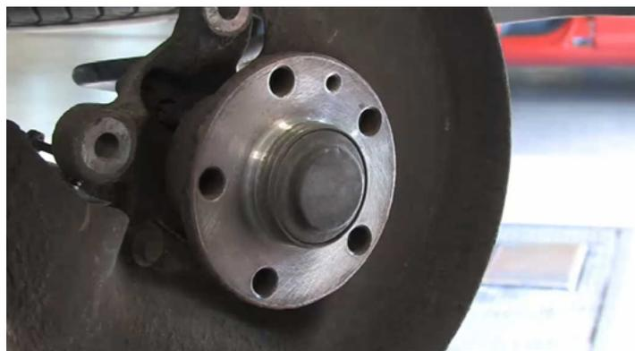
Se prima della riparazione era stata rilevata una vibrazione del freno, prima del montaggio è necessario controllare il sincronismo del mozzo della ruota. A tal fine rispettare i valori prescritti dalla casa costruttrice.
