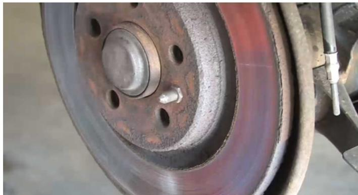
Rimuovere prima la vite di fissaggio del disco del freno (se presente). Quindi smontare il disco del freno.
