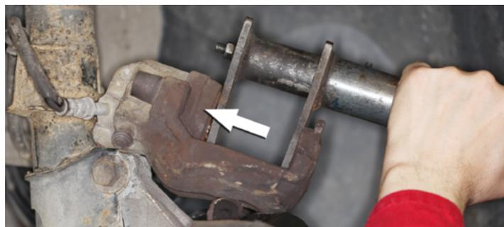
Con l'aiuto di un idoneo attrezzo speciale, spingere il pistoncino della pinza del freno nella sua posizione iniziale. Accertarsi che il pistoncino venga spinto uniformemente e facilmente nell'alloggiamento. Se il pistoncino dovesse muoversi con difficoltà, controllare se è sporco o corrosivo. In caso di dubbio, sostituire la pinza del freno!
