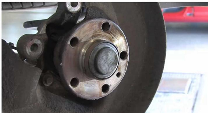
Il modo migliore per eliminare lo sporco e le tracce di ruggine dal mozzo della ruota è quello di usare una spazzola per mozzi. L'uso del detergente per freni TRW impedisce una formazione eccessiva di polvere di frenata.
