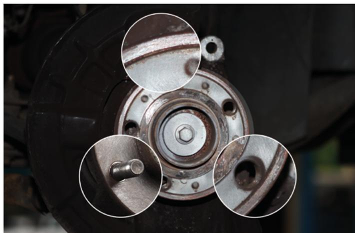
Controllare se la superficie di montaggio per il disco del freno, così come i tiranti a vite o i filetti per i bulloni della ruota sono danneggiati o corrosi. I mozzi della ruota danneggiati devono essere sostituiti.
