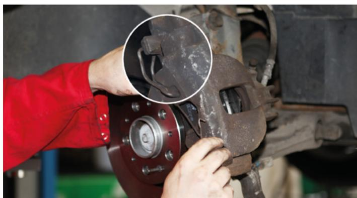
Montare la molla portapastiglia. Accertarsi che la molla sia correttamente montata in sede (nei punti di ancoraggio e al portafreno).
