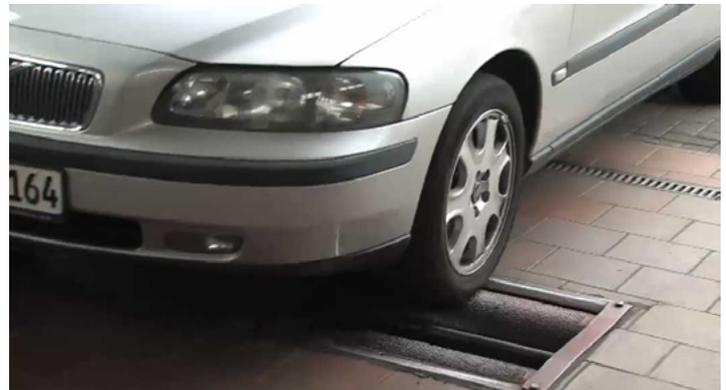
Dopo un giro di prova, controllare il regolare funzionamento dei freni su un banco di prova dei freni. Durante questo controllo, rispettare le norme di legge sullo scostamento della forza frenante per ciascun lato di un asse. Ricordarsi di controllare anche il funzionamento del freno a mano
