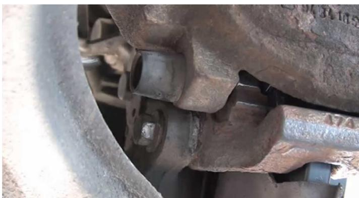
Con l'aiuto dei bulloni di scorrimento, fissare la scatola della pinza del freno al portafreno. Serrare i bulloni di scorrimento con la coppia di serraggio prescritta dalla casa costruttrice.
