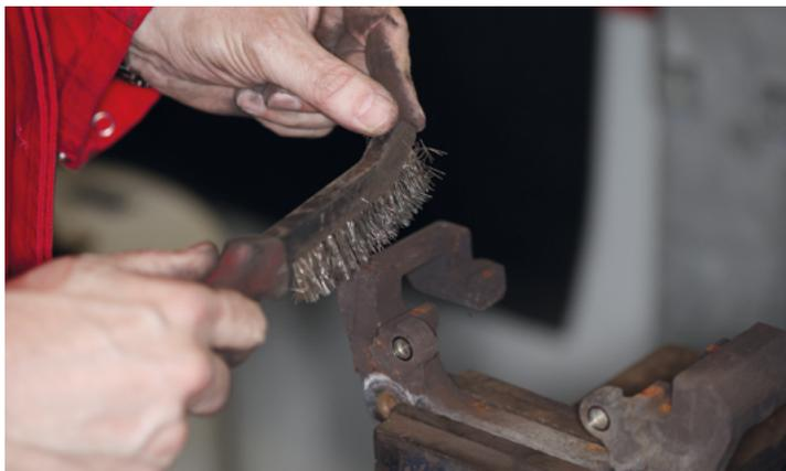
La pulizia accurata del portafreno è di fondamentale importanza per il corretto funzionamento dell'impianto frenante. Soprattutto le superfici sulle quali poggia la pastiglia devono essere prive di sporco e ruggine. Solo così è possibile evitare reclami futuri come grippaggio del freno, imbardata e rumori insoliti!
