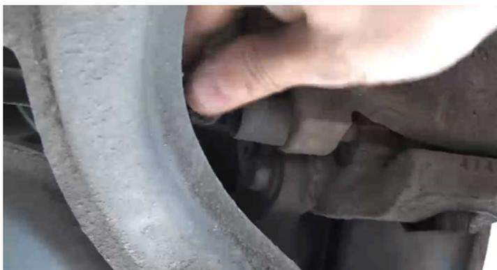
Rimuovere i cappucci parapolvere da entrambi i perni di guida e controllare se sono danneggiati. La facilità di movimento dei perni di guida è molto importante per il corretto funzionamento del freno. Infiltrazioni di acqua e polvere causano fenomeni di corrosione e limitano così la mobilità della pinza del freno.
