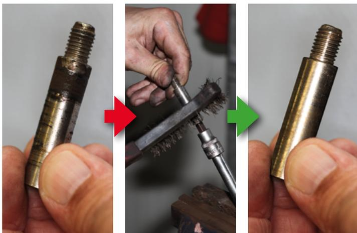
Altrettanto importante è una pulizia accurata dei perni di guida. Solo perni di guida perfettamente puliti permettono all'alloggiamento di scorrere liberamente e quindi un azionamento e allentamento uniformi del freno.
