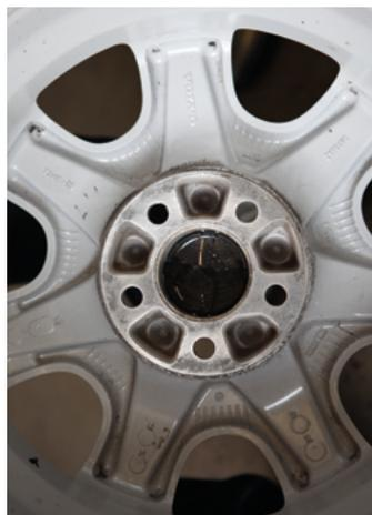
Prima di montare le ruote, ricordarsi di pulire la parte interna dei cerchioni. Soprattutto le superfici d'appoggio del disco del freno devono essere prive di sporco e ruggine. Un cerchio sporco può causare la deformazione del disco del freno. Durante il montaggio dei bulloni della ruota rispettare le informazioni della casa costruttrice sull'ordine e la coppia di serraggio.
