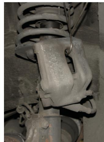
Rimuovere l'alloggiamento dal portafreno e fissarlo all'ammortizzatore a molla. Accertarsi che il flessibile del freno sia allentato e non venga danneggiato.
