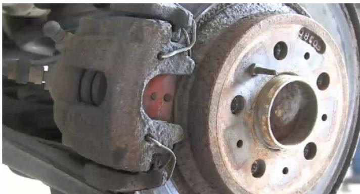
Con l'aiuto di una pinza idonea o di un cacciavite, allentare delicatamente la vite laterale della pastiglia dai due punti di ancoraggio.
