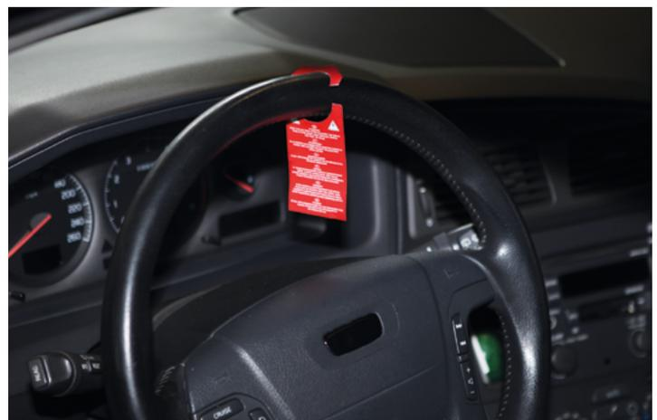
Al termine dei lavori, ricordarsi di appendere in posizione ben visibile al volante l'etichetta fornita in dotazione con le pastiglie. Così il cliente viene informato sulle norme di rodaggio per le nuove pastiglie del freno e voi evitate inutili reclami.
