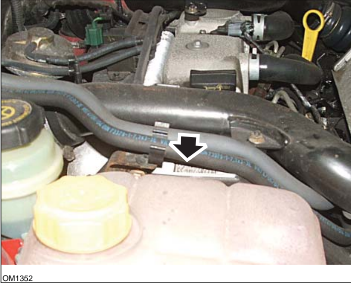
1,8 TDCi Motorlar: - Enjektör etiketi, resimde ok ile gösterilmiştir - Yan görünüm
