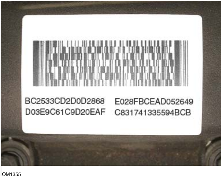
Etiqueta do injector - indica quatro números de 16 dígitos
