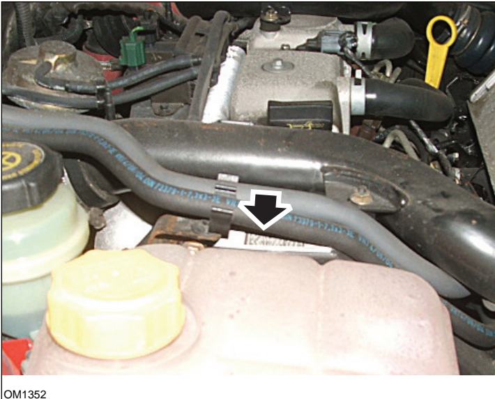
Motores 1,8 TDCi: - Etiqueta do injector ilustrada com uma seta - Vista lateral
