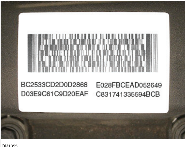
Einspritzdüsen-Label - mit 16-stelligem Code
