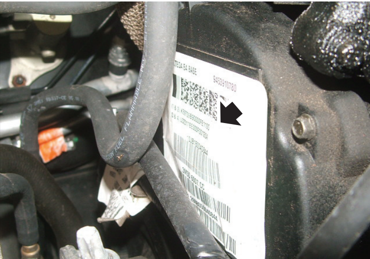
Die Einspritzdüsen-Codes sind mit Pfeilen markiert
