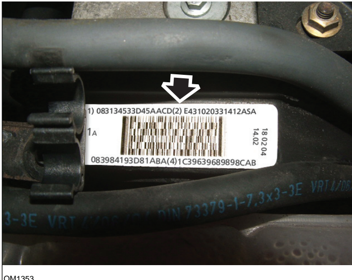
Einspritzdüsen-Label - mit 16-stelligem Code
