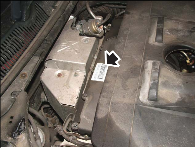
Moteur 2,0 TDCi - Étiquette d'injecteur indiquée par une flèche sur l'illustration - Vue latérale
