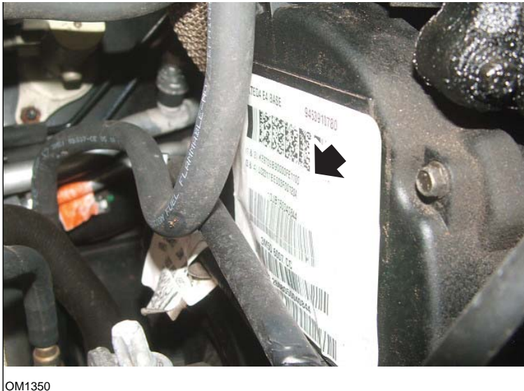
Codes de l'injecteur indiquée par une flèche sur l'illustration
