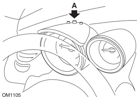
1. Mettez le contact, puis, dans les 4 secondes qui suivent, sélectionnez l'écran d'intervalle d'entretien en appuyant sur le bouton **A** situé en haut de l'ensemble instrumentation. (Appuyez de manière répétée jusqu'à l'affichage de l'intervalle d'entretien).
