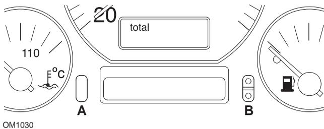
1. Pour réinitialiser le code témoin d'intervalle d'entretien (SRI), mettez le contact. Maintenez enfoncé le bouton du compteur kilométrique **A**. En maintenant le bouton **A** enfoncé, coupez le contact.
