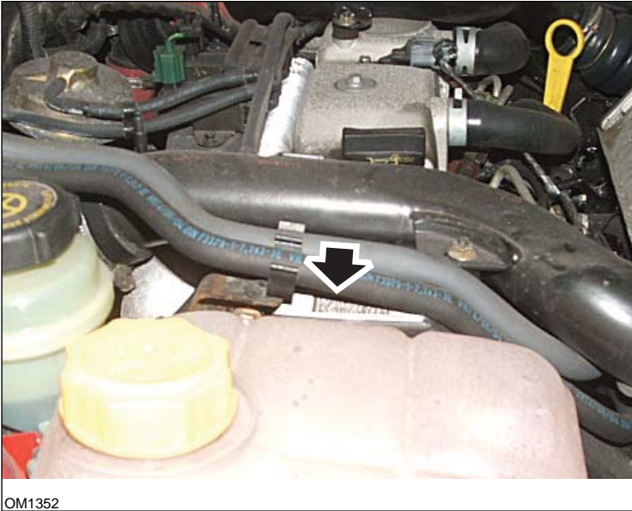
OM1352 Motores 1.8 TDCi: - Etiqueta de inyectores indicada con una flecha: Vista lateral
