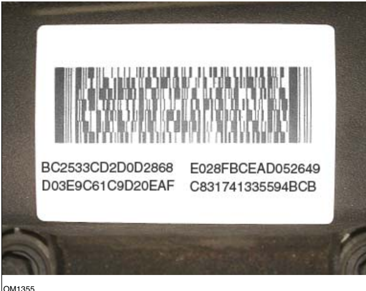
Etiqueta de inyectores: muestra cuatro números de 16 dígitos
