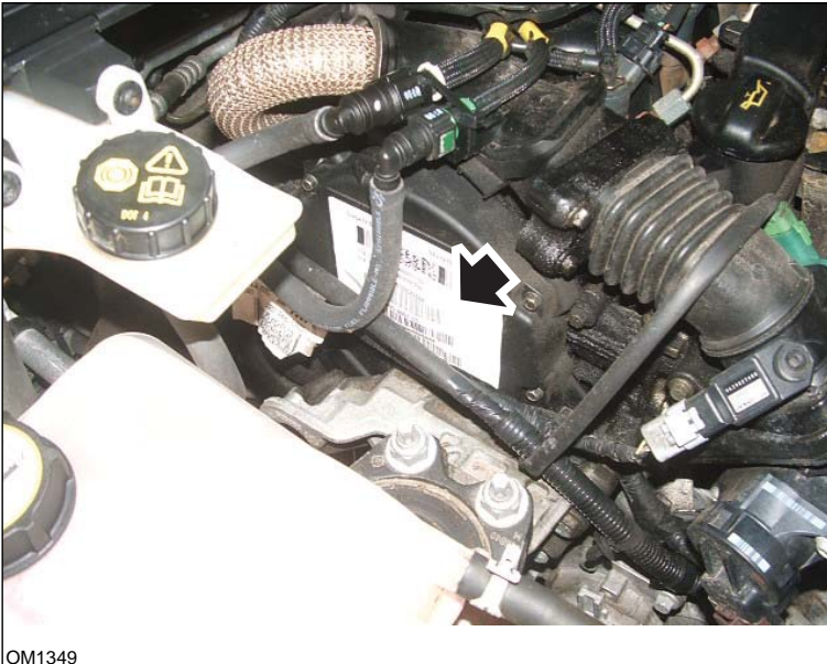
1.6 TDCi Motor: - Einspritzdüsen-Label mit Pfeil gekennzeichnet
