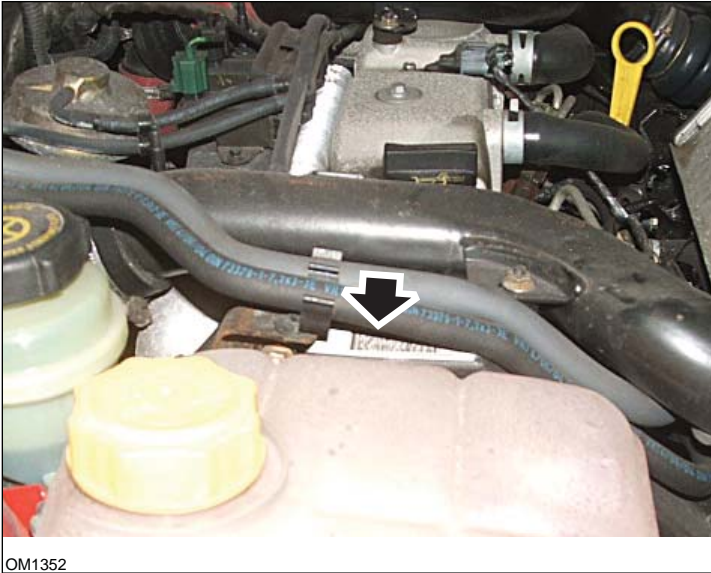
1,8 TDCi Motor: - Einspritzdüsen-Label mit Pfeil gekennzeichnet - Seitenansicht
