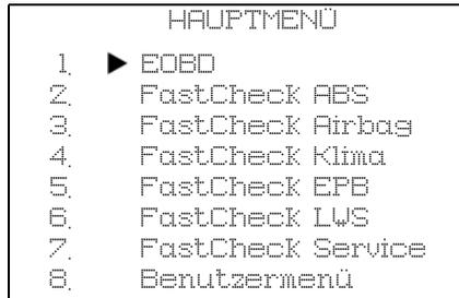
Verwenden Sie die Tasten ▲ und ▼, um die Anwendung "FastCheck Airbag" auszuwählen und drücken Sie anschließend ✓ zur Bestätigung. Um zum vorherigen Menü zurückzukehren, drücken Sie die Taste ✕.
