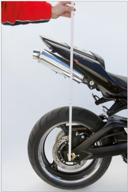
Messung der Höhenänderung lotrecht über der Hinterachse Measuring the change in perpendicular height above the rear axle Mesure de la modification de la hauteur verticalement au-dessus de l'essieu arrière
