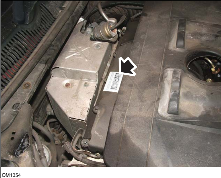
Moteur 2,0 TDCi - Étiquette d'injecteur indiquée par une flèche sur l'illustration - Vue latérale
